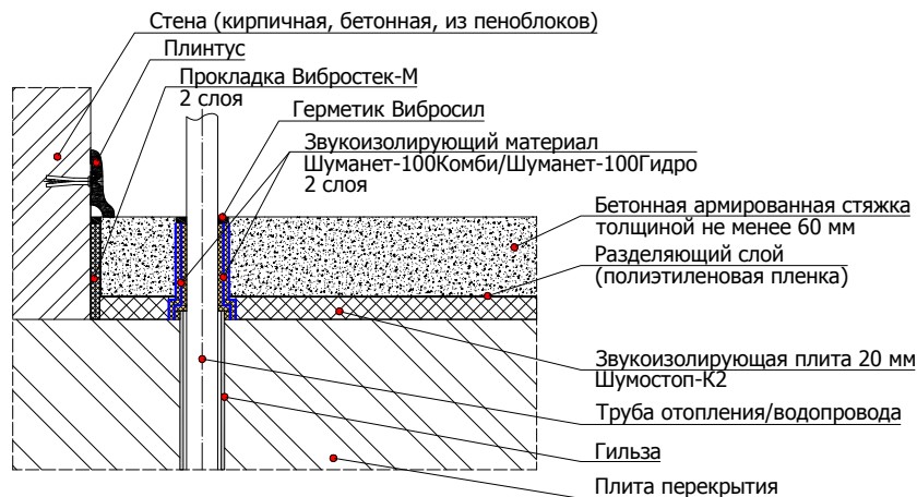
6.4.3 Схема примыкания конструкции плавающего пола с применением звукоизолирующих плит Шумостоп-K2 в один слой к стене и трубе отопления/водопровода
