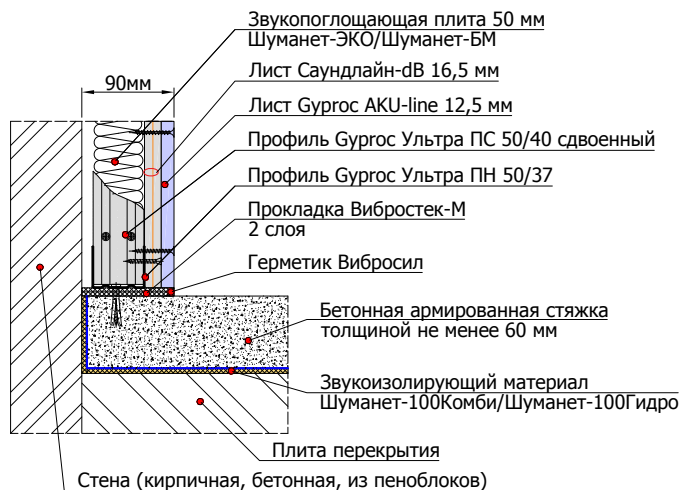
4.2.1 Примыкание облицовки стены на независимом сдвоенном каркасе 50 мм к конструкции "плавающего" пола
